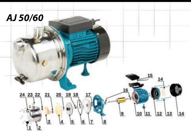
Einstufige, selbstansaugende Kreiseloberflächenpumpe, ausgestattet mit einem System, das die Saugleistung dank der Verwendung eines Venturi-Rohrs erhöht, das zum Pumpen von saube-rem, kaltem Wasser aus den eigenen Ansaugöffnungen und zum Erhöhen des Drucks ausgelegt ist. Der Pumpenkörper und die Welle des mit Wasser in Berührung kommenden Teils sind aus Edelstahl (INOX-Version) gebaut. Die Pumpe hat ein Netzkabel mit Stecker. Der Pumpenmotor ist mit einem Wärmeschutz ausgestattet.
