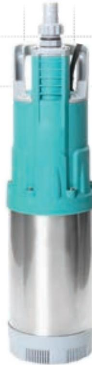
Eine Reihe von Pumpen mit den gleichen Hydraulikelementen wie bei Pumpen Multi IP 800 INOX, jedoch anstelle eines Schwimmerschalters wurde eine Pumpensteuerungsautomatik eingebaut. Wenn das Auslassventil geschlossen ist, wird die Pumpe ausgeschaltet und geht in den Standby-Modus, wobei ein konstanter Druck im System aufrechterhalten wird. Die Pumpe wird automatisch eingeschaltet, wenn das Auslassventil geöffnet wird.
